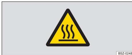
Abb. 7 Warnschild für heiße Oberflächen auf dem Ladegerät.
