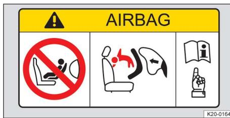
Abb. 1 Airbag-Aufkleber an der Sonnenblende (Prinzipdarstellung).
